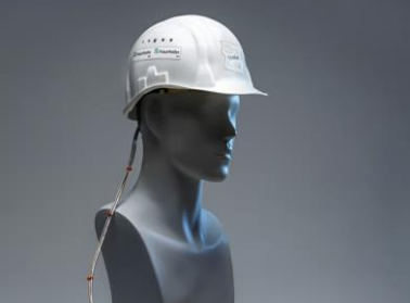
Mũ bảo hiểm dễ dàng đo chính xác tải trọng rung trong các hoạt động hàng ngày.
